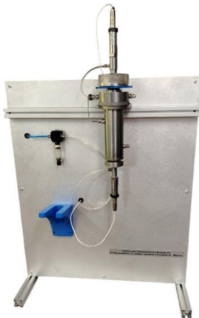
Рисунок 1 – Общий вид приборов для определения коэффициента газопроницаемости твердых веществ и материалов М2метр
