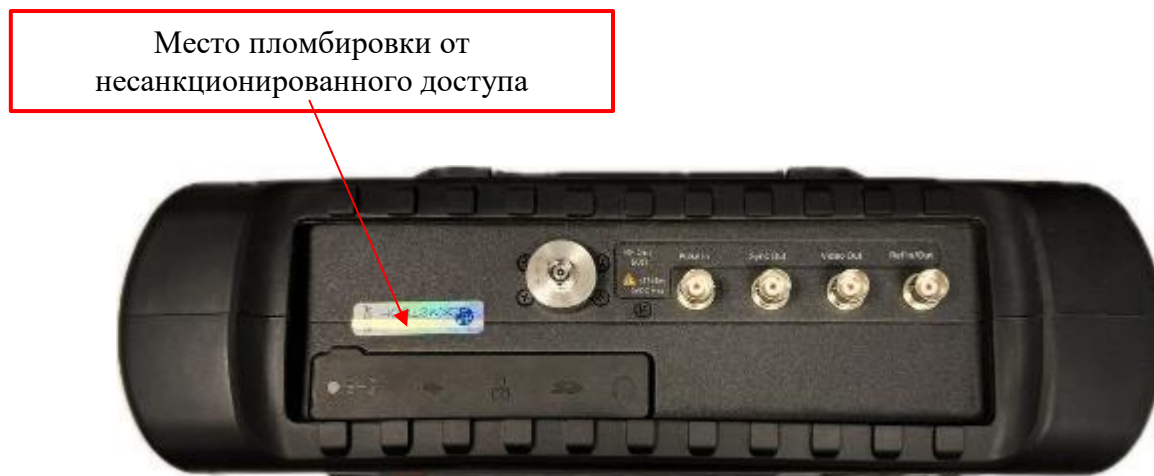
Рисунок 3 – Схема пломбировки от несанкционированного доступа
