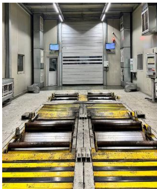
Рисунок 2 – Общий вид измерителя частоты вращения роликов стенда С-RTS-F модификации С-RTS-F-0212-6, зав. № RTS-190400
