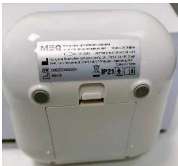
Рисунок 2 – Схема маркировки измерителя артериального давления и частоты пульса автоматического MEQ
