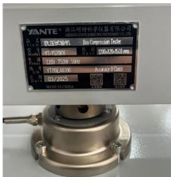
Рисунок 2 – Общий вид маркировочной таблички с указанием заводского номера
