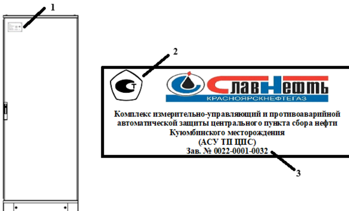
Рисунок 1 – Место нанесения маркировочных табличек (1) на шкафы в составе АСУ ТП ЦПС и места нанесений заводского номера (3) и знака утверждения типа (2)
