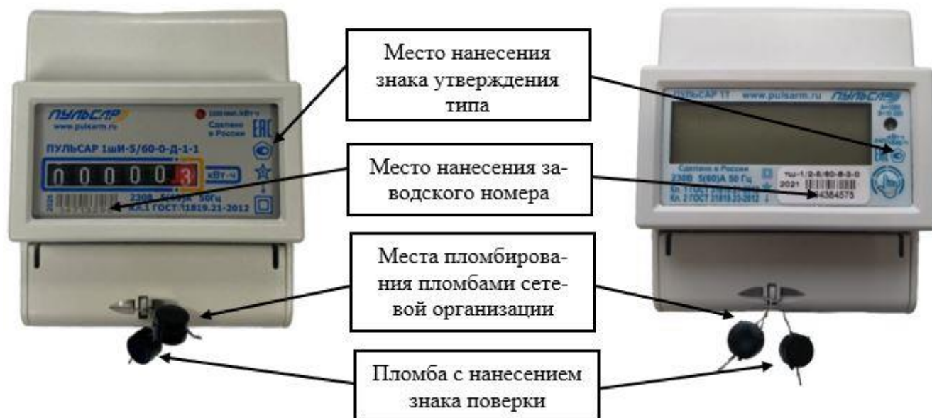
Рисунок 2 – Общий вид счетчиков в корпусе с установкой на дин-рейку с указанием места ограничения доступа к местам настройки (регулировки), места нанесения знака утверждения типа, места нанесения заводского номера
