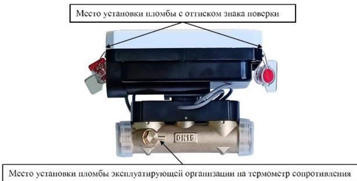
Рисунок 2 – Схема пломбировки средства измерений
