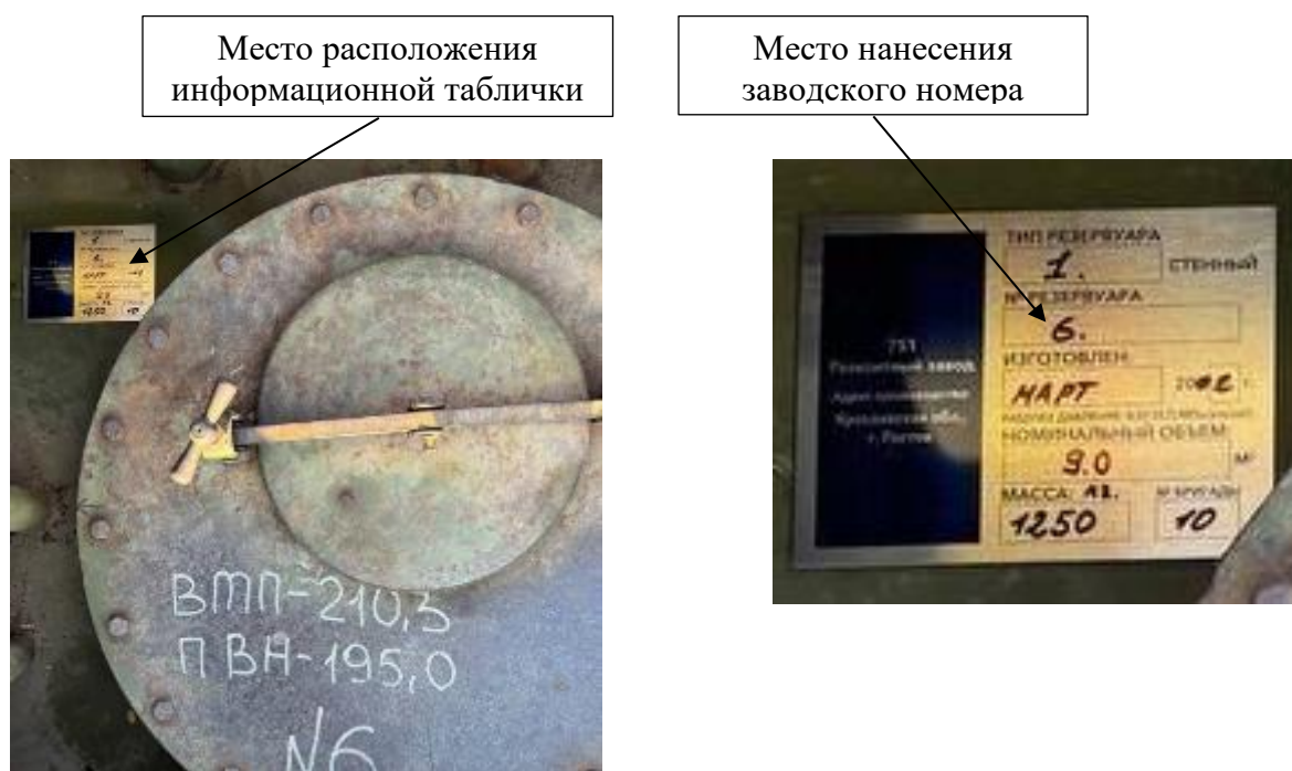
Рисунок 3 – Общий вид горловины резервуара № 6, обозначение места нанесения заводского номера на информационную табличку
