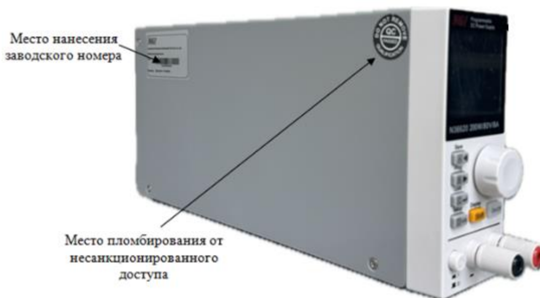
Рисунок 2 – Схема пломбирования от несанкционированного доступа и место нанесения заводского номера источников питания постоянного тока программируемых N36600
