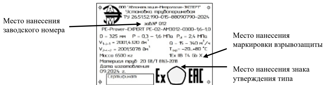
Рисунок 3 – Обозначения мест нанесения знака утверждения типа и заводского номера
