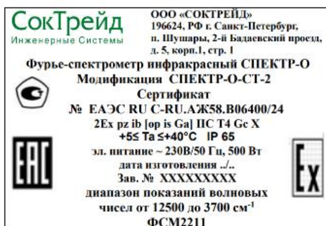
Рисунок 4 – Шильдик спектрометра СПЕКТР-О-СТ-2 с блоком интерферометра ФСМ 2211
