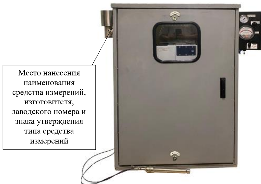
Рисунок 1 – Общий вид спектрометра СПЕКТР-О-СТ-1 (с оптоволоконным зондом)
