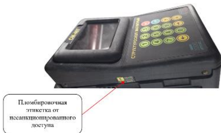
Рисунок 2 – Схема пломбирования структуроскопов от несанкционированного доступа
