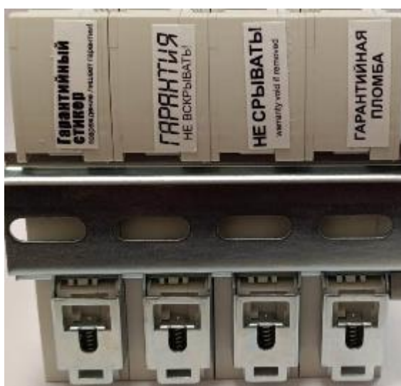
Рисунок 2 – Виды гарантийных стикеров и схема установки
