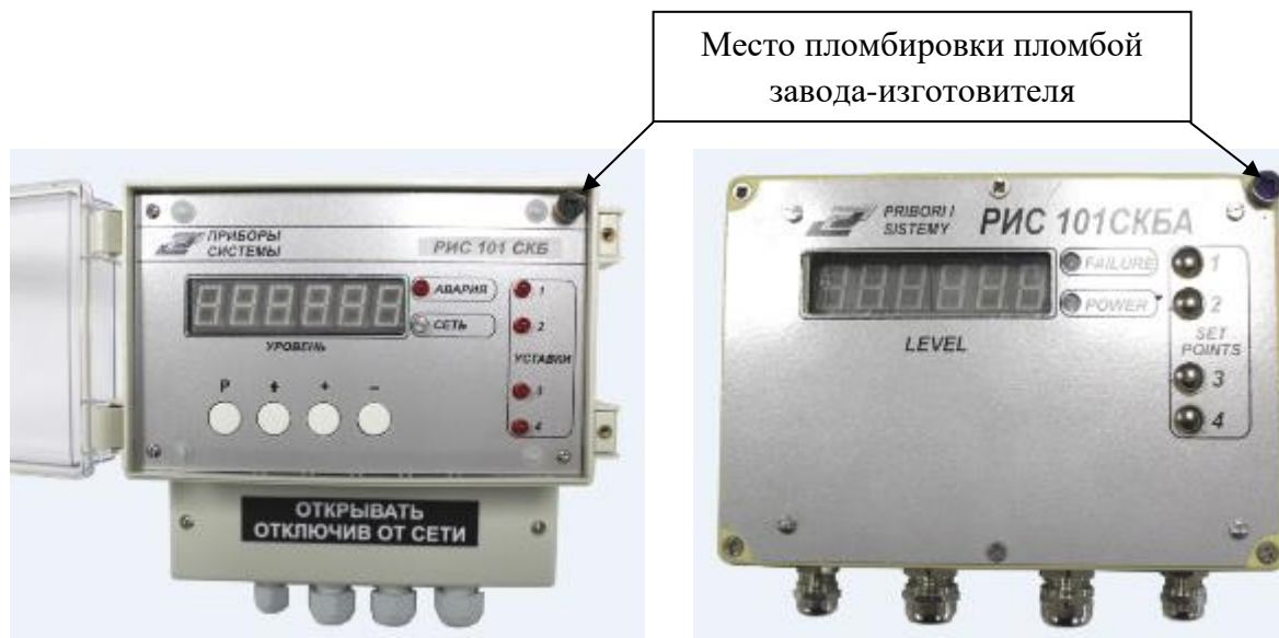
Рисунок 2 – Схема пломбировки преобразователя передающего датчика-индикатора от несанкционированного доступа, обозначение мест пломбировки пломбой завода-изготовителя
