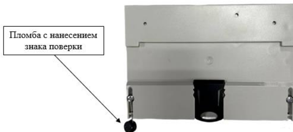
Рисунок 3 – Общий вид счётчиков с установкой на дин-рейку с указанием места ограничения доступа к местам настройки (регулировки)
