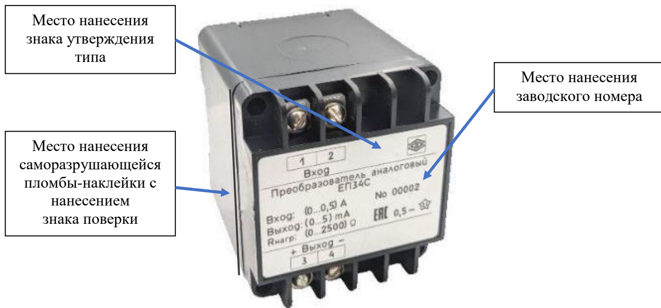
Рисунок 1 – Общий вид исполнений преобразователей со значениями преобразования входного сигнала силы переменного тока до 5 А с указанием места ограничения доступа к местам настройки (регулировки), места нанесения знака утверждения типа, места нанесения заводского номера
