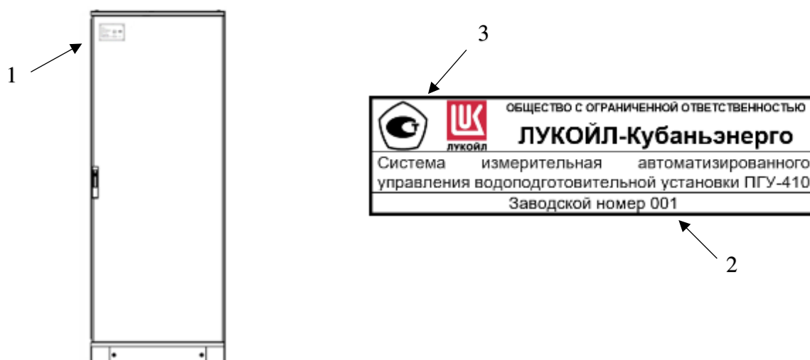
Рисунок 1 – Место нанесения маркировочных табличек (1) на шкафы в составе системы, места нанесений заводского номера (2) и знака утверждения типа (3)
