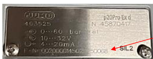
Рисунок 2 – Идентификационная табличка датчиков давления JUMO p20Pro
