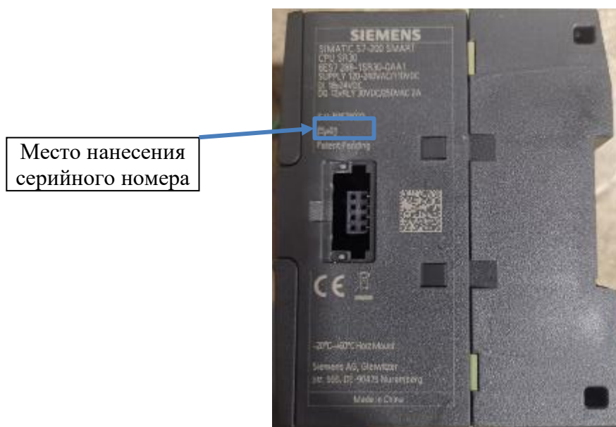
Рисунок 2 – Вид справа модуля центрального процессора с указанием места нанесения серийного номера
