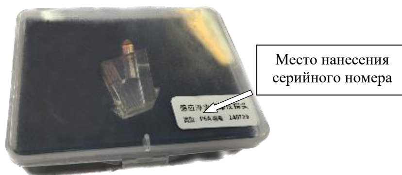
Рисунок 4 – Общий вид пьезоэлектрического преобразователя с призмой в футляре с метом нанесения серийного номера
