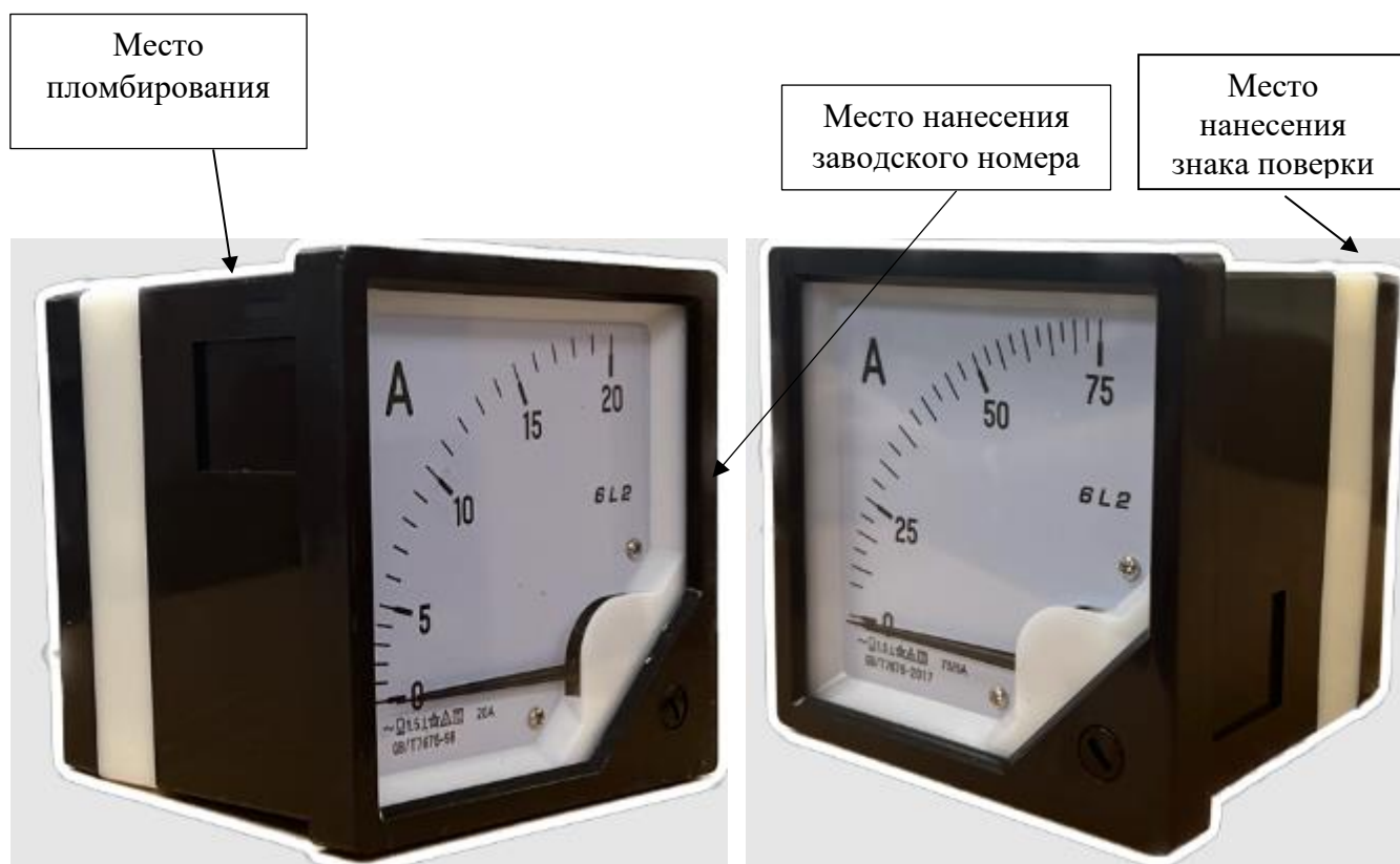
Рисунок 1 – Общий вид амперметров, места нанесения заводского номера, пломбы и знака поверки
