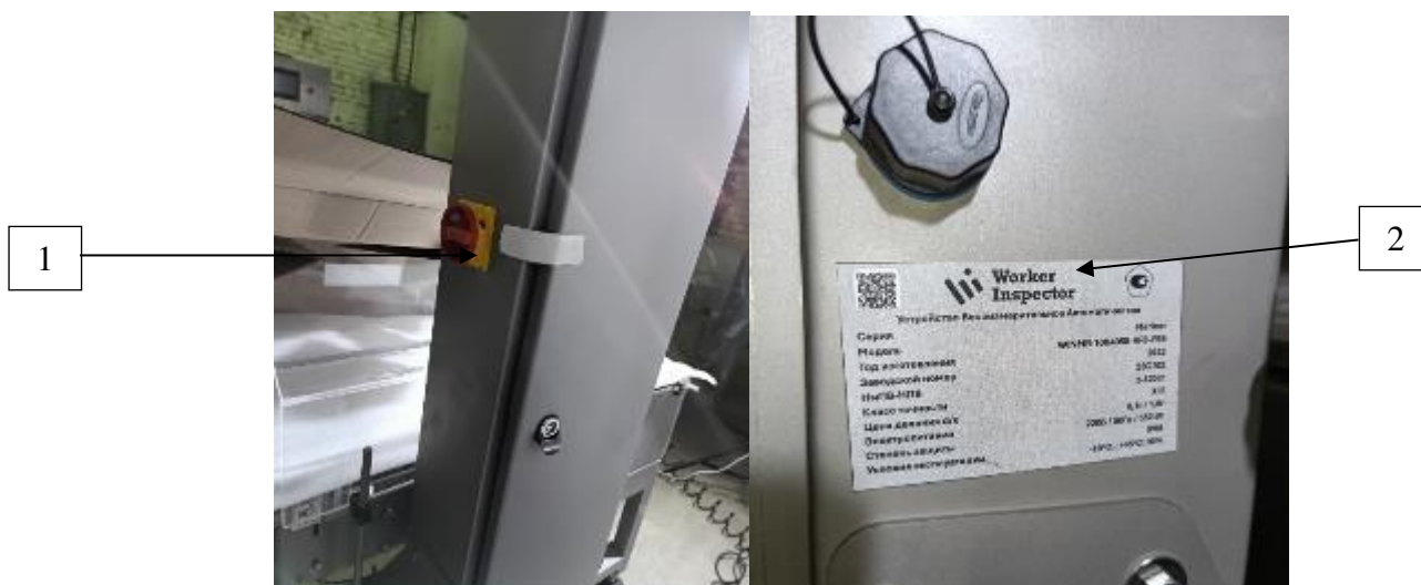
Рисунок 2 – Место пломбирования и нанесения знака поверки (1), место нанесения маркировочной таблички (2) со знаком утверждения типа, заводским номером
