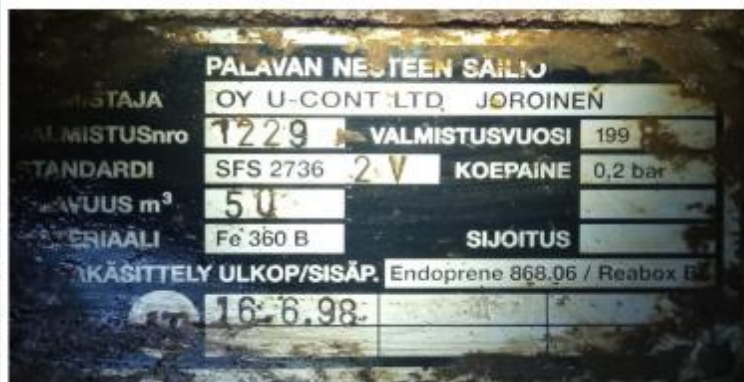
Рисунок 3 – Маркировочная табличка и горловина резервуара РГС-50 зав.№ 1229
