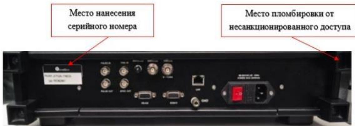
Рисунок 2 – Место нанесения серийного номера и схема пломбировки
