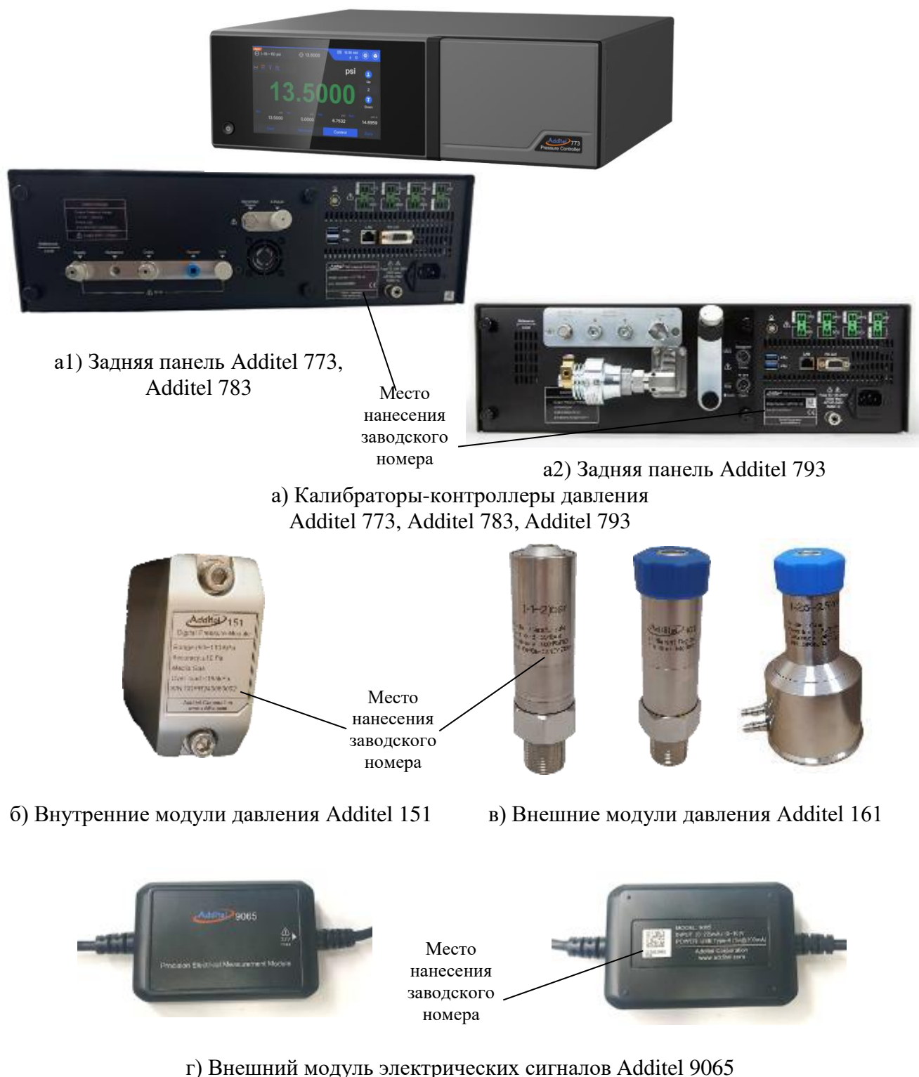
Рисунок 1 – Общий вид калибраторов-контроллеров давления Additel с указанием места нанесения заводского номера
