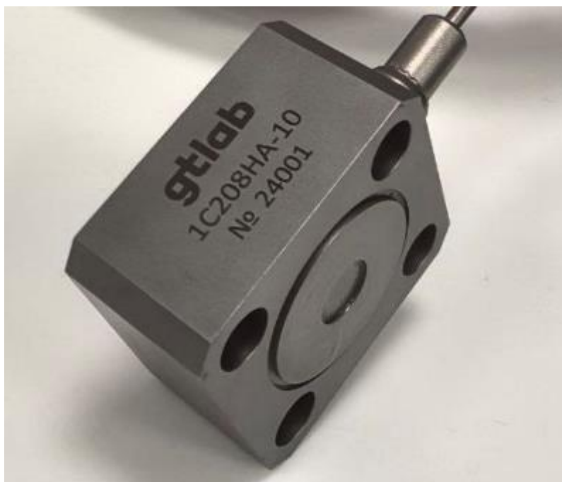
Рисунок 1 – Внешний вид акселерометров 1С208НА-10
