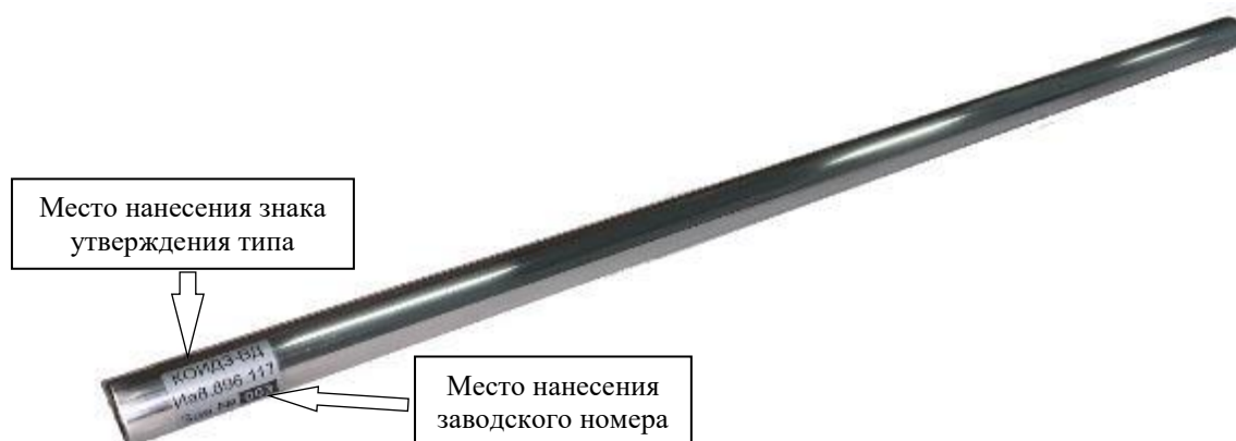
Рисунок 1 – Общий вид образцов искусственных дефектов КОИДЗ-ВД Иа8.896.117
