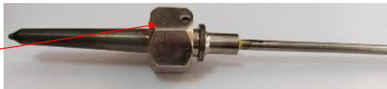
Рисунок 1 – Общий вид преобразователей с указанием места нанесения заводского номера
