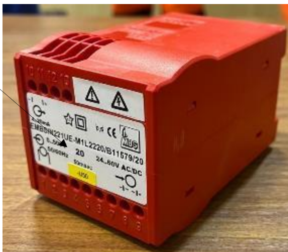
Рисунок 1 – Общий вид преобразователей и место нанесения заводского номера
