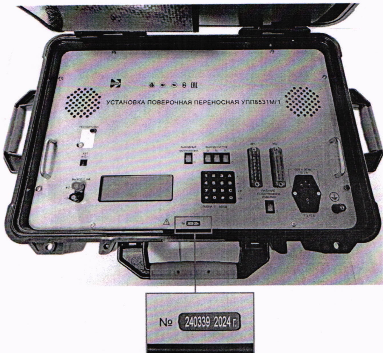
Рисунок 1.2 – Лицевая панель УПП8531М/1
