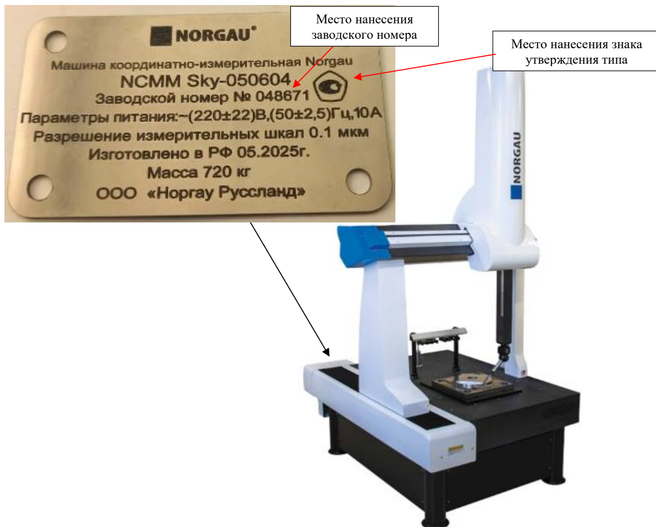
Рисунок 2 – Общий вид маркировочной наклейки машин координатно-измерительных NORG AU NCMM, место ее нанесения и место нанесения знака утверждения типа
