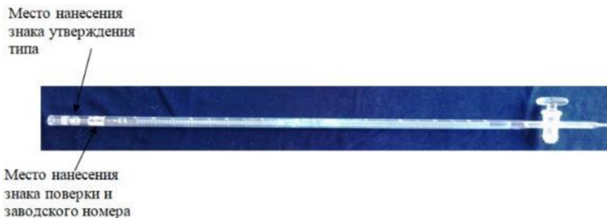
Рисунок 2 – Общий вид бюреток 1-го класса точности типа I исполнения 1 с указанием мест нанесения знака утверждения типа, знака поверки и заводского номера
