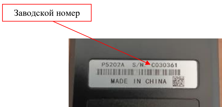
Рисунок 3 – Фрагмент нижней панели пробников дифференциальных высоковольтных P5202A
