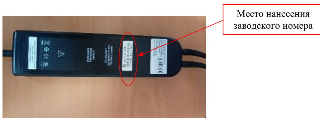
Рисунок 2 – Нижняя панель пробников дифференциальных высоковольтных P5202A
