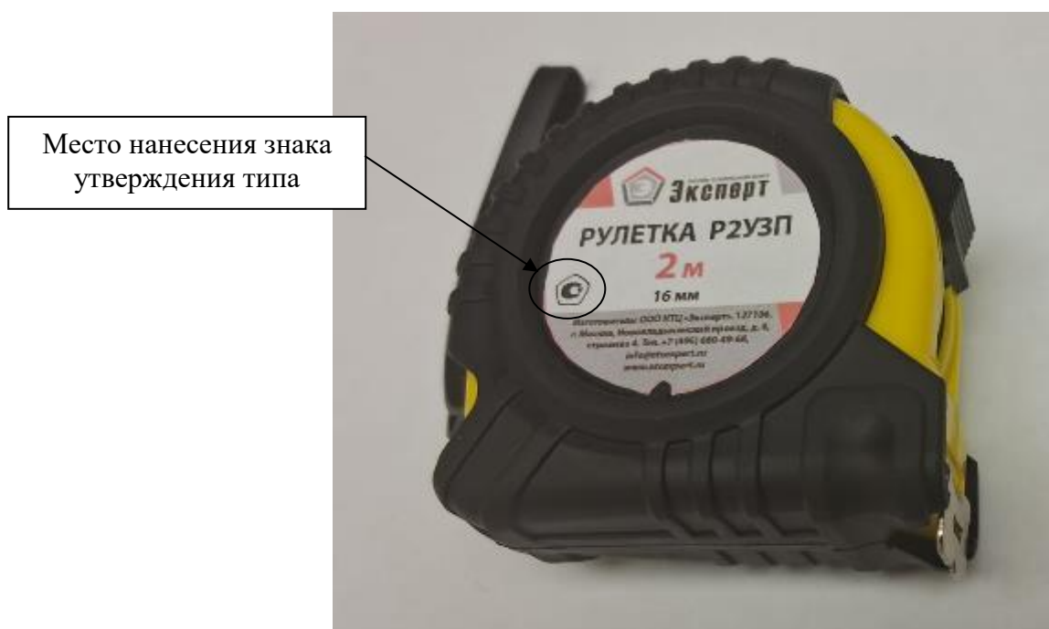
Рисунок 1 – Общий вид рулеток модели Р2УЗП и места нанесения знака утверждения типа
