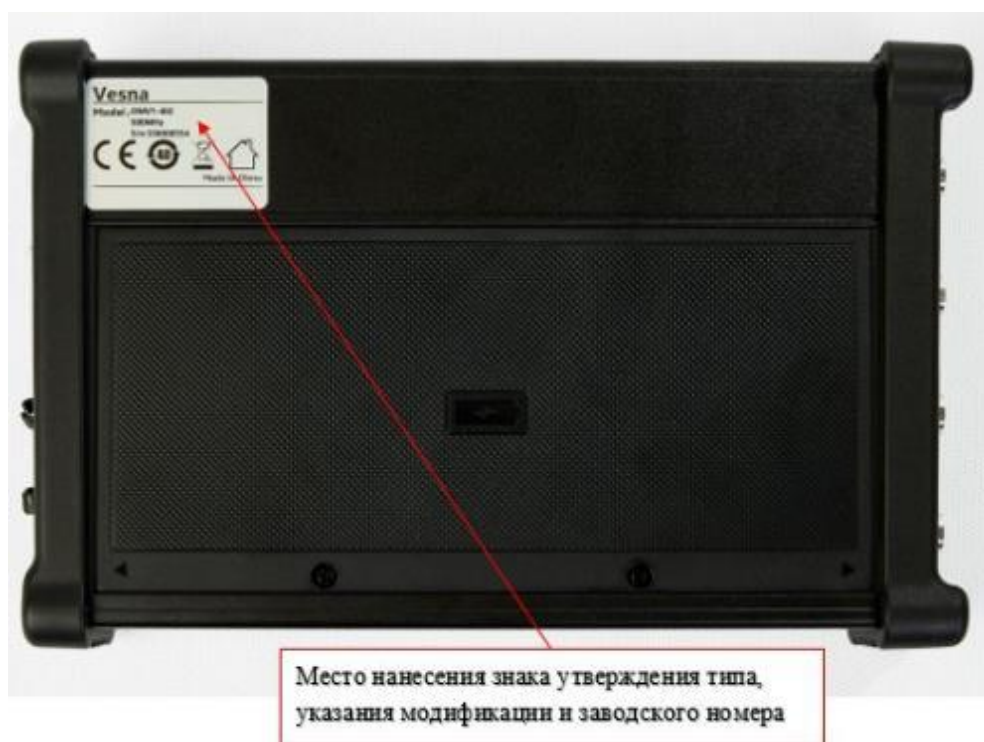
Рисунок 5 – Вид нижней панели модификаций OMV1-402; OMV1-402A
