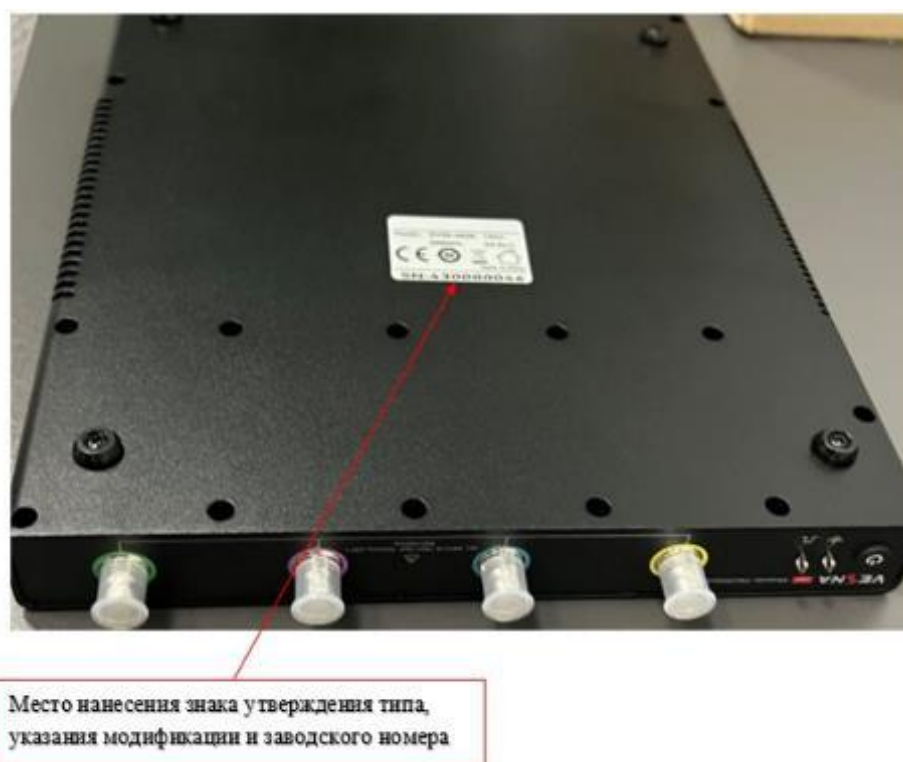
Рисунок 6 – Вид нижней панели модификаций OMS3-402; OMS3-403; OMS3-405
