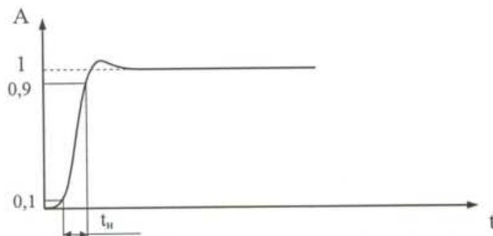
Рис. 4. Изображение испытательного импульса при измерении времени нарастания переходной характеристики t_n .
