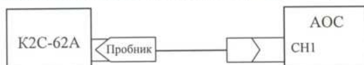
Рис. 1. Структурная схема измерения основной относительной погрешности коэффициентов отклонения и развёртки.
