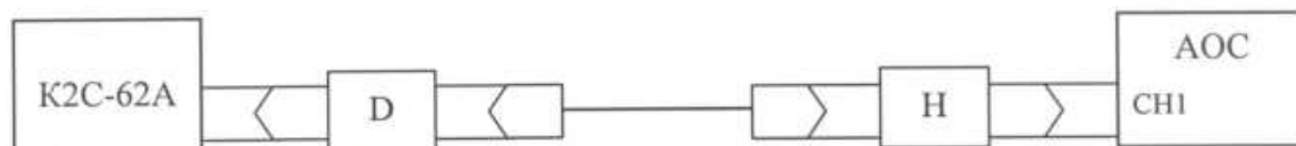
Рис. 2. Структурная схема определения полосы пропускания периодического сигнала. D – аттенюаторы фиксированные типа Д2-31, Д2-32.
