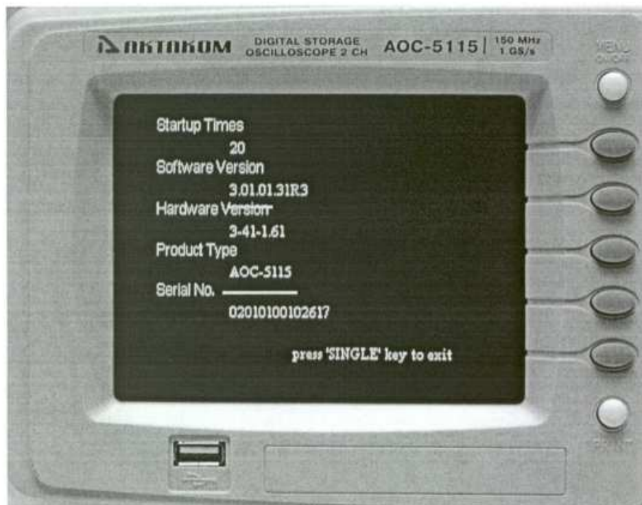
Рисунок 2. Идентификационные данные ПО осциллографов в меню «UTILITY»/«Статус» (выделены подчеркиванием).
