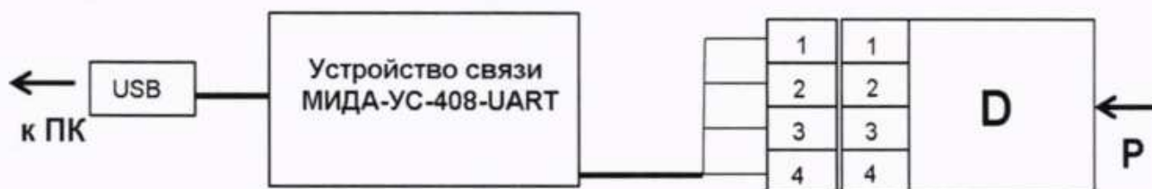
Рисунок Д.3 - Схема подключения датчиков с протоколом обмена Mida на основе интерфейса UART к персональному компьютеру
