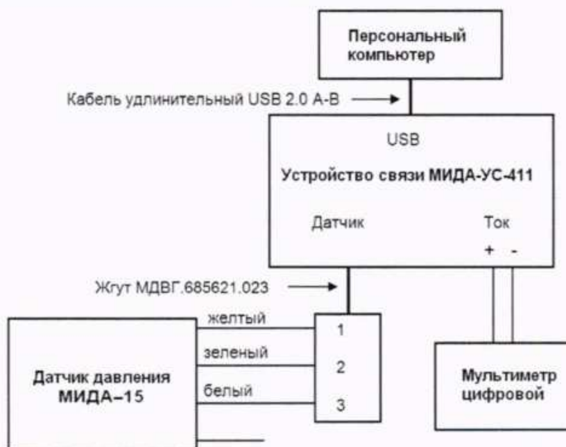
Рисунок В.1- Блок-схема подключения датчика с выходным сигналом от 4 до 20 мА
