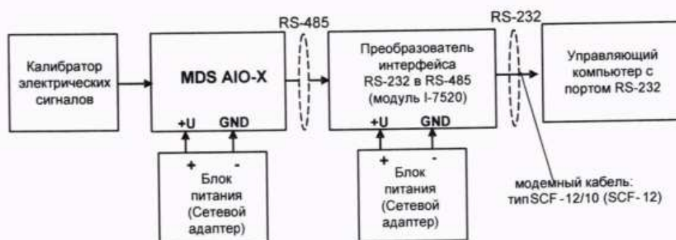
Рисунок 8 – Схема подключения для определения абсолютной погрешности измерений компенсации влияния температуры «холодного спая»
