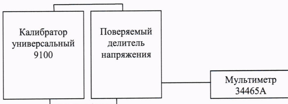
Рисунок 4 - Схема измерений напряжения переменного тока частотой в частотном диапазоне от 20 до 20000 Гц
