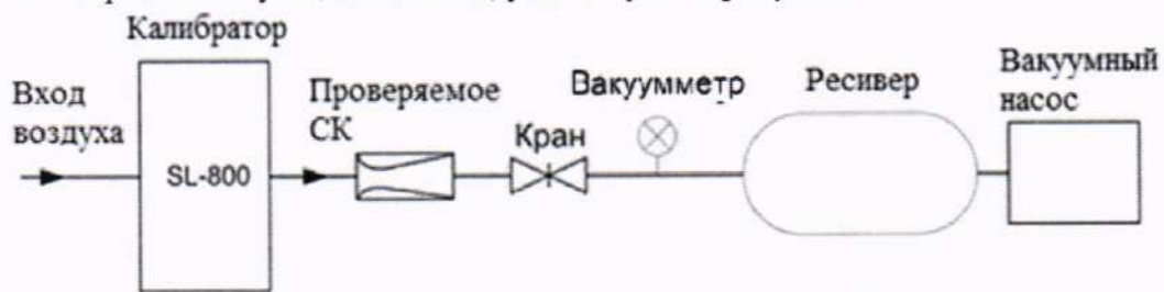
Рисунок 1. Схема подключений СК к ЭУ-5
