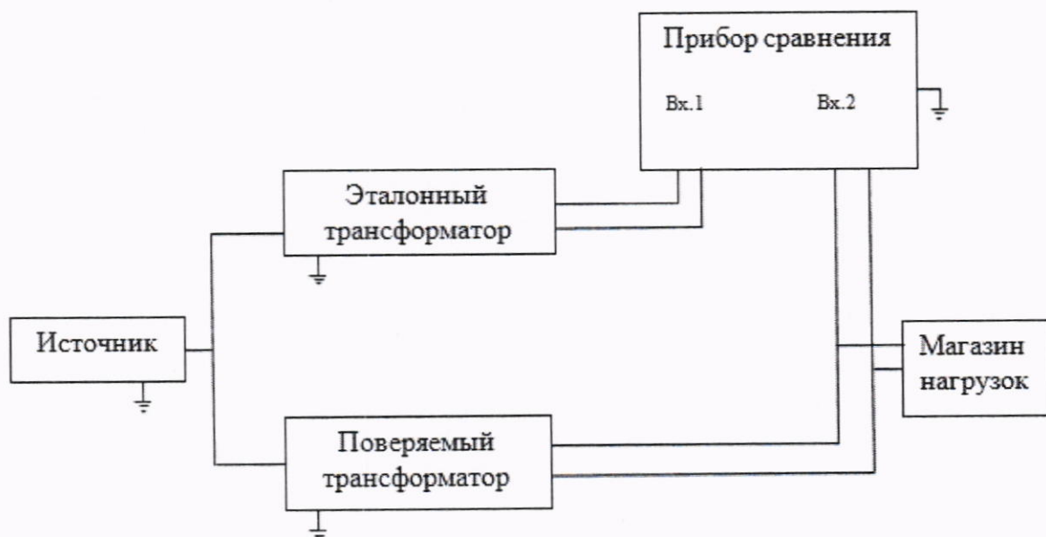
Рисунок 4 – Схема определения токовых и угловых погрешностей трансформаторов
