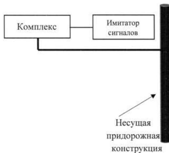
Рисунок 2 – Схема проведения измерений
