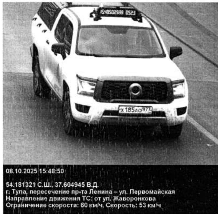
Рисунок 1 – Пример размещения «ИВС-21» на транспортном средстве
