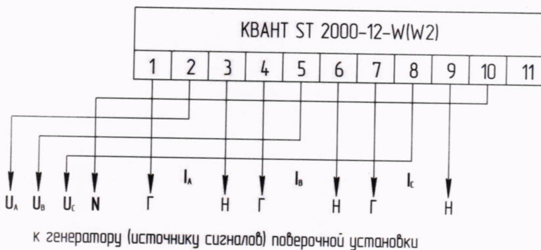
б) Схема подключения счетчиков для варианта исполнения корпуса W и W2 к генератору (источнику сигналов) поверочной установки
