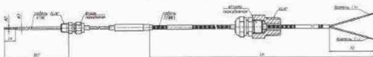
Рисунок Г.5г - Габаритный чертёж ПТ моделей ТХА 001.05Сп, ТХА 001.05Сп-Ех, ТХА 001.05Сп-Ехс, ТХА 001.05Сп-Ехл с двумя установочными узлами, с кабелем ПТФФЗ
