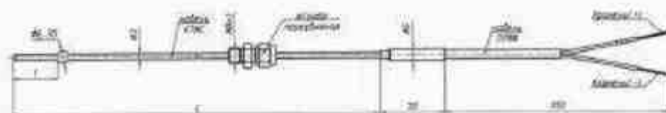
Рисунок Г.5 - Габаритный чертёж ПТ моделей ТХА 001.05, ТХА 001.05-Ех
