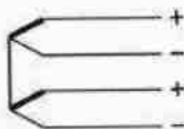
Рисунок Д.1а – Схема соединений для ПТ с изолированным рабочим спаем (индекс «И» в позиции «Тип спая» в записи при заказе, см. Приложение Б) с одной термопарой
