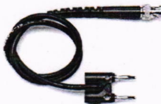
Рисунок 3 – Измерительный кабель для определения уровня пульсаций
