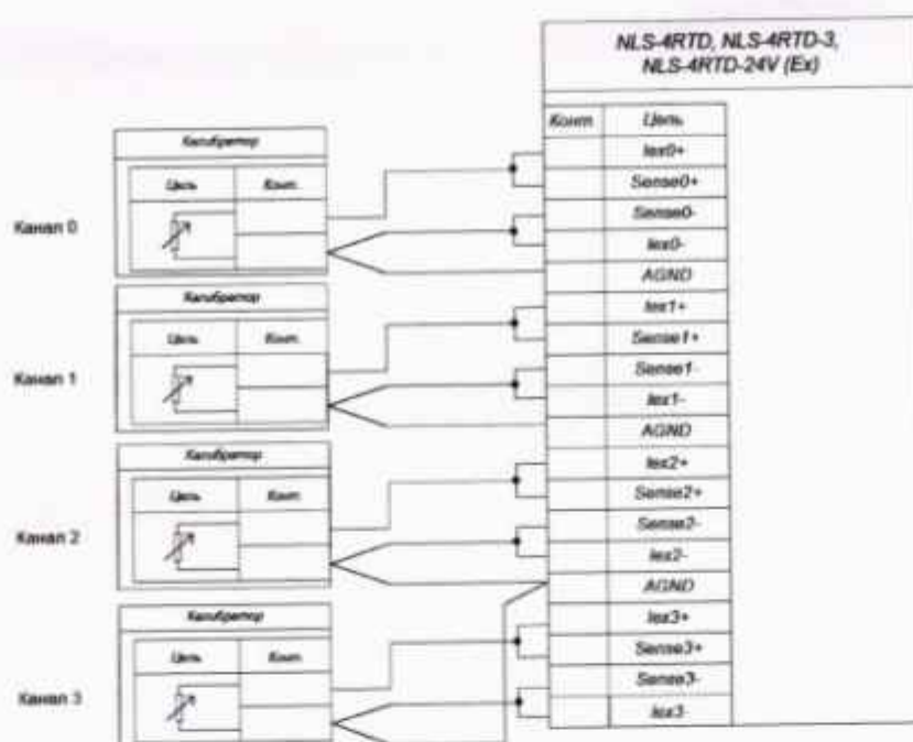
Рис. Б. 9 – Схемы подключения для определения приведенной к диапазону измерений основной погрешности измерений сигналов от термопреобразователей сопротивления в температурном эквиваленте (для трехпроводных датчиков) модулей модификаций NLS-4RTD, NLS-4RTD-3, NLS-4RTD-24V
