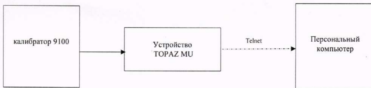
Рисунок Б.3 – Схема структурная определения погрешностей измерений (преобразований) напряжения постоянного тока
