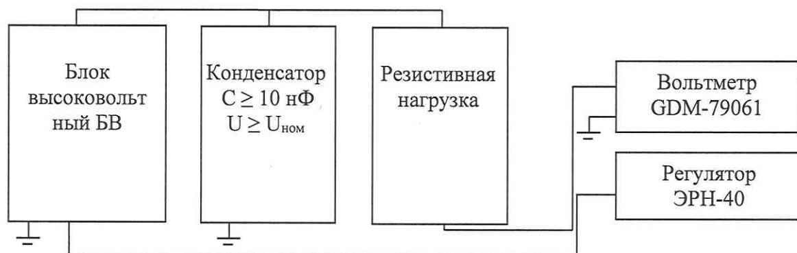
Рисунок 4 – Схема определения погрешности измерений силы постоянного тока
