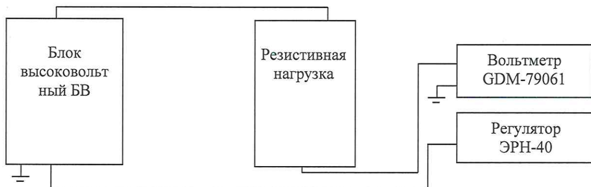
Рисунок 3 – Схема определения погрешности измерений силы переменного тока
