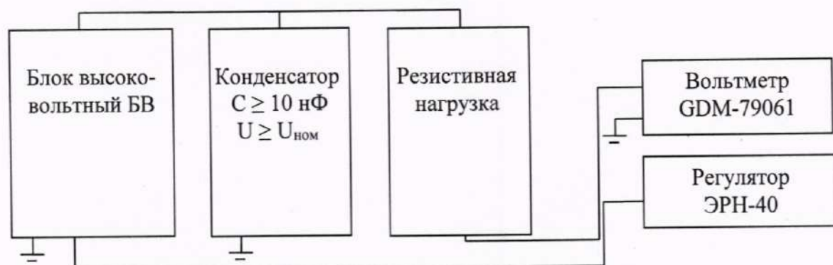
Рисунок 4 – Схема определения погрешности измерений силы постоянного тока
