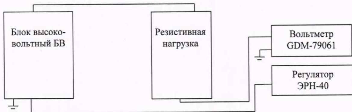
Рисунок 3 – Схема определения погрешности измерений силы переменного тока
